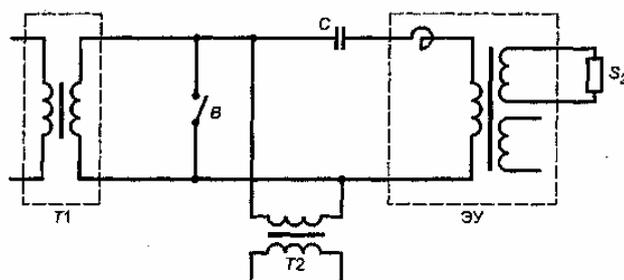
*T1* — питающий трансформатор; *C* — конденсатор отбора мощности емкостного трансформатора; *T2* — трансформатор напряжения для осциллографирования; ЭУ — электромагнитное устройство емкостного трансформатора; *B* — высоковольтный короткозамыкатель; *S<sub>2</sub>* — нагрузка основной вторичной обмотки
