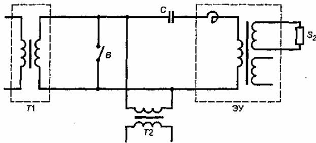
*T<sub>1</sub>* — питающий трансформатор; *C* — конденсатор отбора мощности емкостного трансформатора; *T<sub>2</sub>* — трансформатор напряжения для осциллографирования; *ЭУ* — электромагнитное устройство емкостного трансформатора; *B* — высоковольтный короткозамыкателем; *S<sub>2</sub>* — нагрузка основной вторичной обмотки
